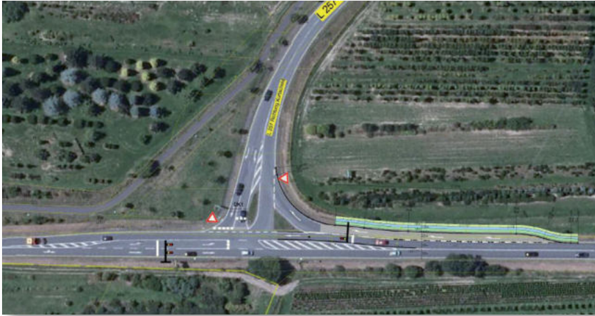
Variante verkehrs- und zeitabhängige Lichtsignalanlage mit Rechtsabbiegestreifen
